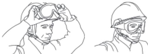
La correa elástica incluye una hebilla regulable para ajustar la presión de las gafas sobre la cara del usuario y optimizar así el confort y la protección.
